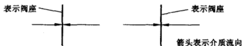
图 1-2 双向各自密封的双阀座阀门
