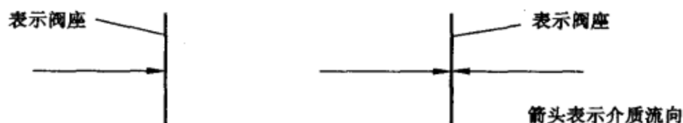
图 1-3 一个阀座单向密封,一个阀座双向密封的双阀座阀门
